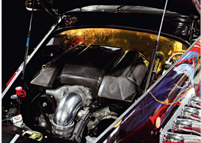
DiMora Vicci 6.2車內部的LS-A汽缸6.2V8機械增压引擎。
